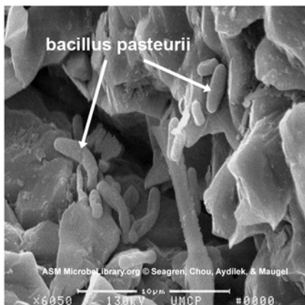
[Bacillus pasteurii와(좌) 모래 입자 사이에 생성된 방해석(우) 사진]
